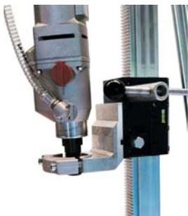
Если на станину Leonardo-200 необходимо установить бормотор без монтажной площадки, то вместо штатной необходимо использовать специальную пластину быстросъемного крепления с хомутом Ø60 мм (опция), которая крепится к каретке станины таким же образом.
