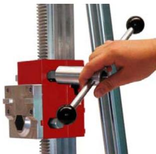
Рукоятка для перемещения каретки устанавливается на шестигранный вал привода каретки.
