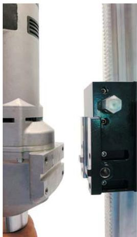
Еще один способ установки бормотора на станину Leonardo-200 (только если корпус бормотора имеет монтажную площадку) – привинтить бормотор 4-мя болтами М8 непосредственно к каретке станины.
